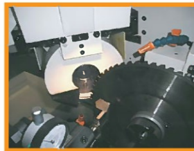
● 先端傾き45° 研磨姿勢 先端逃げ角 0° ~ +25° 先端傾き角 ~±45°
