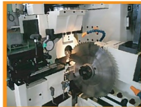
● 先端研磨姿勢 先端逃げ角 0° ~ +25° 先端傾き角 ~±45°
